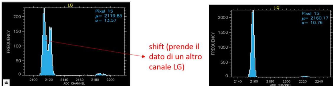
Fig. 59. Istogramma del 15-esimo pixel LG prima (a sinistra) e dopo (a destra) la modifica al codice attivando il campionamento di varianza.
