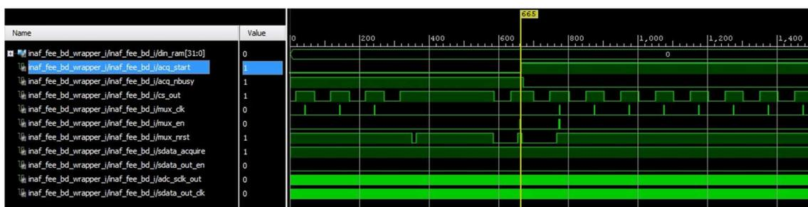
Fig. 62. Screenshot da ILA Chipscope relativi all'attivazione del segnale "mux\_en".
